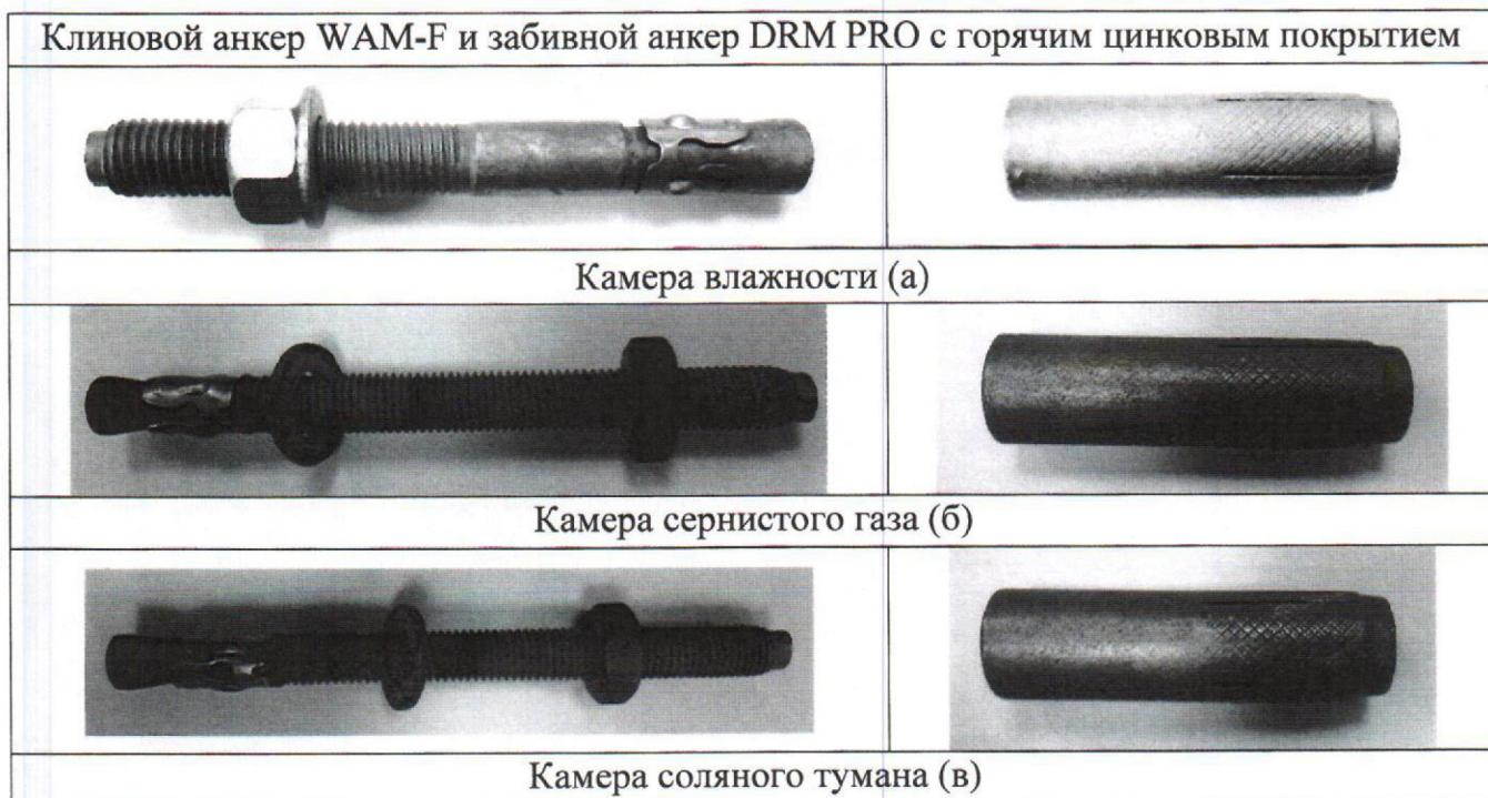
Рис. 3. Внешний вид анкеров с горячим цинковым покрытием после испытаний в камерах влажности (а), сернистого газа (б) и соляного тумана (в).
