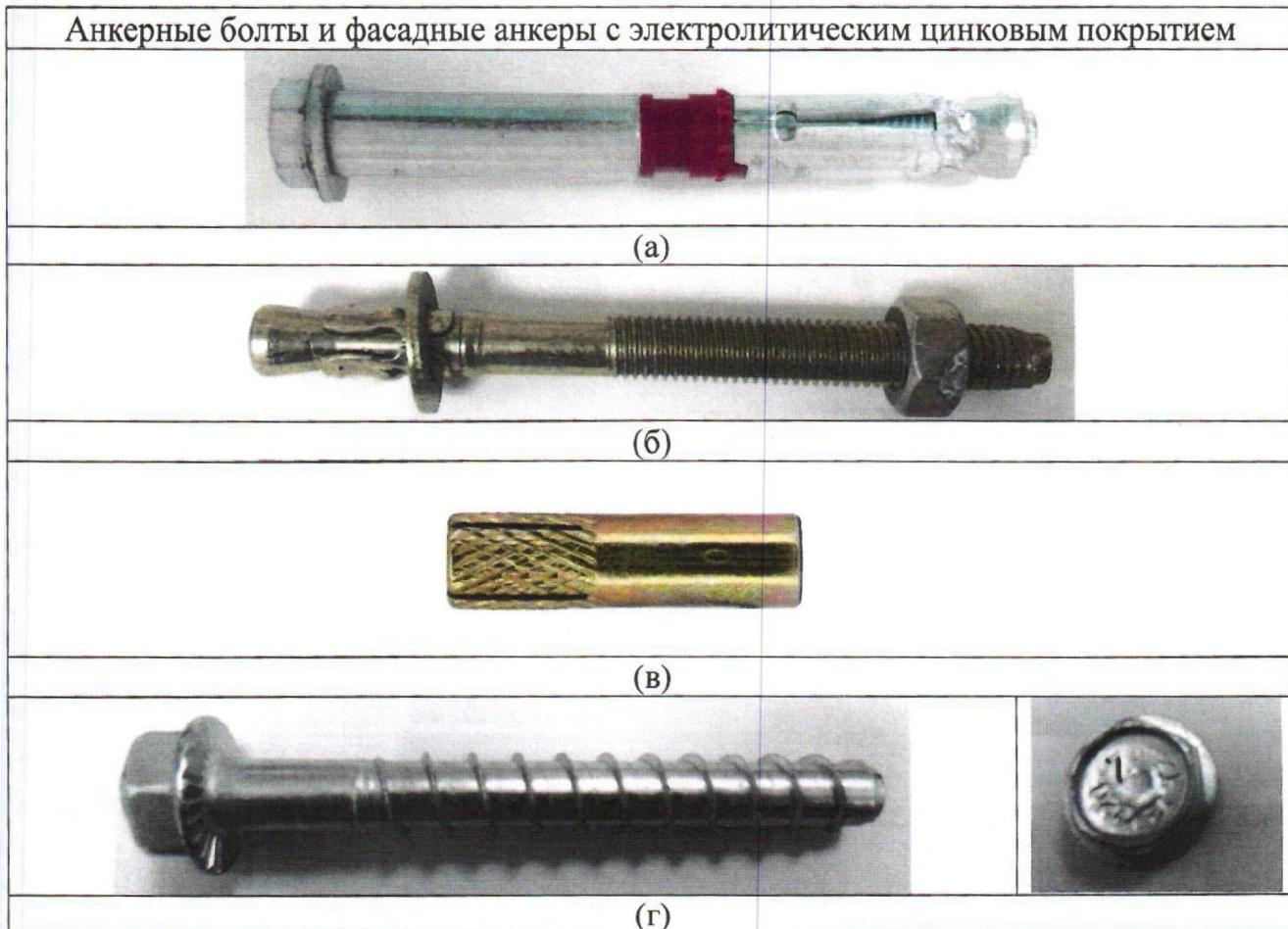
Рис. 1. Внешний вид анкеров с гальваническим цинковым покрытием с голубой (а, г) и радужной (б, в) пассивацией после испытаний в камере влажности.
